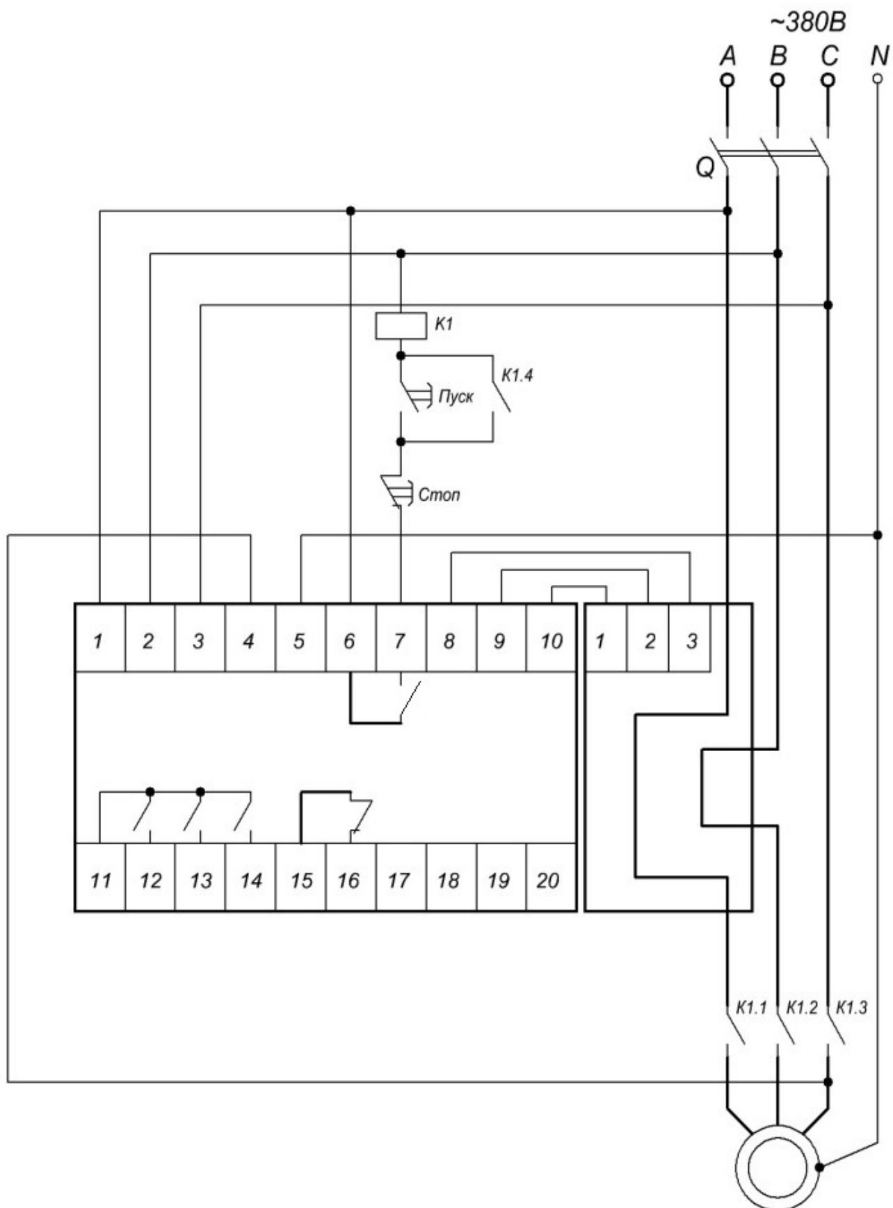
Г2. Схема подключения УЗД-2-XXXX
